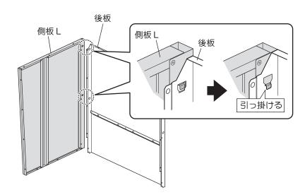
2) トラスねじ (M4 × 10) 3 本 [調理油煙回収ユニット付属品または別売品] で、側板 L を後板に固定します。
