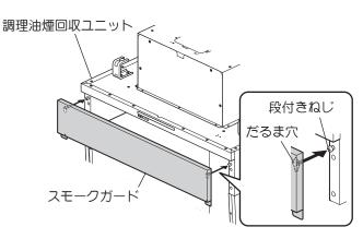
2) スモークガードを調理油煙回収ユニット側に押さえつけながら上方に持ち上げ、トラスねじ (M4 × 12)2 本〔調理油煙回収ユニット付属品〕で取り付けます。
