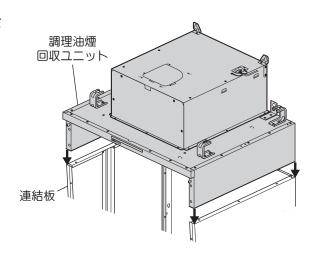
2) 調理油煙回収ユニット下側から、調理油煙回収ユニットの側面および背面をトラスねじ(M4×10)各3本〔調理油煙回収ユニット付属品または別売品〕でそれぞれ固定します。
